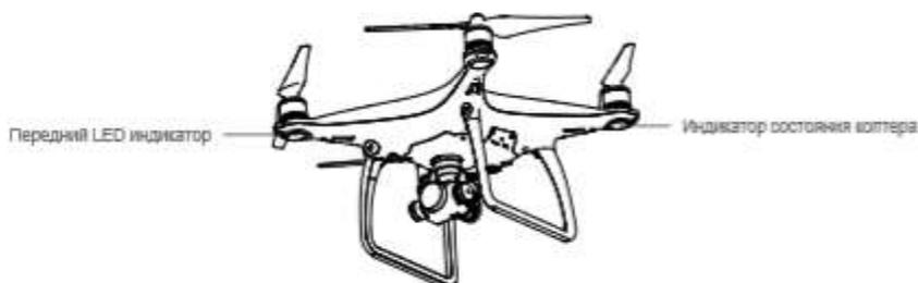
Передние LED индикаторы показывают ориентацию коптера. Когда коптер включен, передние LED индикаторы светятся постоянным красным цветом, чтобы показать где находится нос у коптера. Индикаторы состояния коптера, показывают состояние полетного контроллера. Обратитесь к таблице ниже, для получения дополнительной информации об индикаторах состояния коптера:
